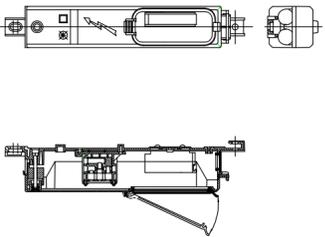
PORTAFUSIBILE SEZIONABILE UNIPOLARE CON FUSIBILE CILINDRICO DA 2A 9G
